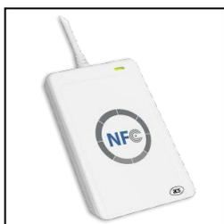
ACR125U è un lettore/scrittore di smart card senza contatto collegato a PC sviluppato con la tecnologia senza contatto a 13.56 MHz. E' il primo lettore/scrittore di carte contactless al mondo conforme CCID che segue sia ISO 14443 che ISO 18092. Questo dispositivo è progettato per supportare non solo le card MIFARE® e ISO 14443 Tipo A e B, ma anche i tag FeliCa e NFC.
